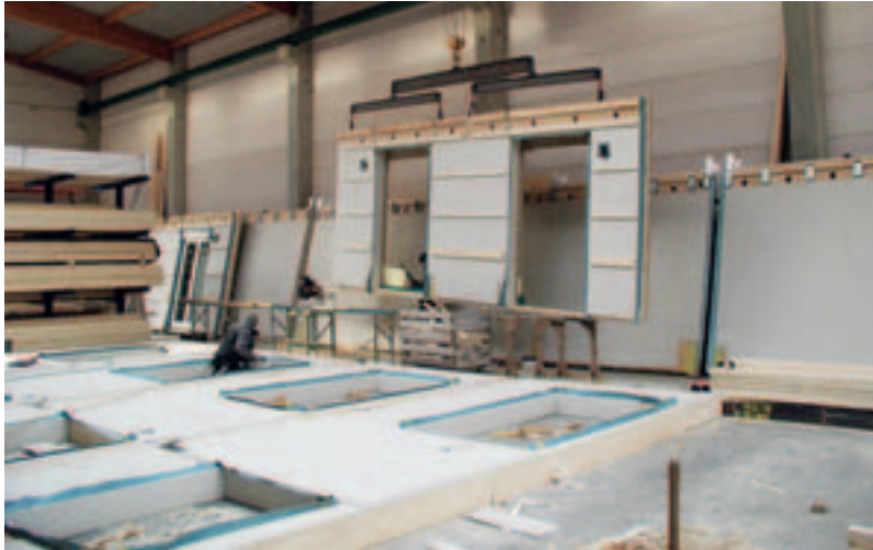
Um nach RAL-GZ 222 zertifiziert zu werden, müssen die Betriebe auch den sicheren Transport der Holztafelelemente in der Werkstatt gewährleisten
